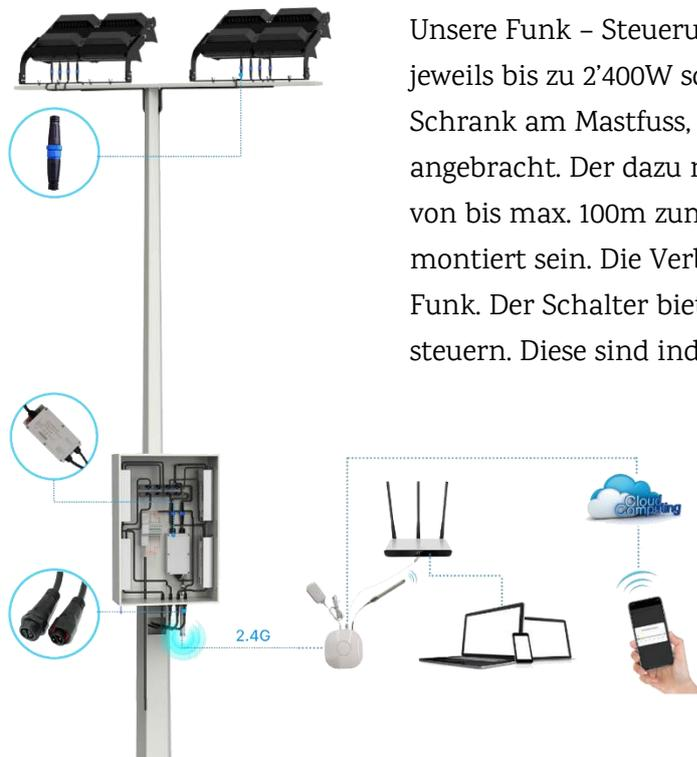
Unsere Funk – Steuerung (Zigbee) benötigt Controller, welche jeweils bis zu 2'400W schalten kann. Mit Vorteil sind diese im Schrank am Mastfuss, oder allenfalls in einer Box am Mast angebracht. Der dazu nötige Gateway kann in einer Entfernung von bis max. 100m zum letzten zu erreichenden Controller montiert sein. Die Verbindung zum Schalter erfolgt ebenfalls per Funk. Der Schalter bietet die Möglichkeit, bis zu 6 Szenen zu steuern. Diese sind individuell programmierbar je nach Bedarf.
